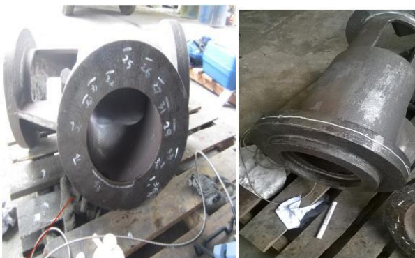
Fig.14: NDT - UT Inspection
